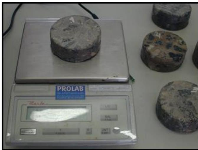
FIGURA 2: Pesagem dos corpos de prova
